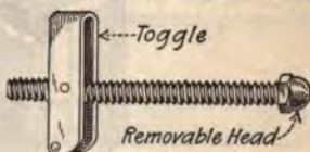
FIG. 7.—Plumbers' toggle bolt.
